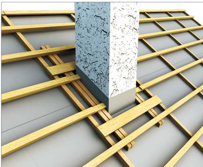
Das Vordere Abdeckprofil der Kamineinfassung sollte die gleiche Länge wie die Ziegel betragen. Biegen Sie die Ziegel über den Wasserfalz.
