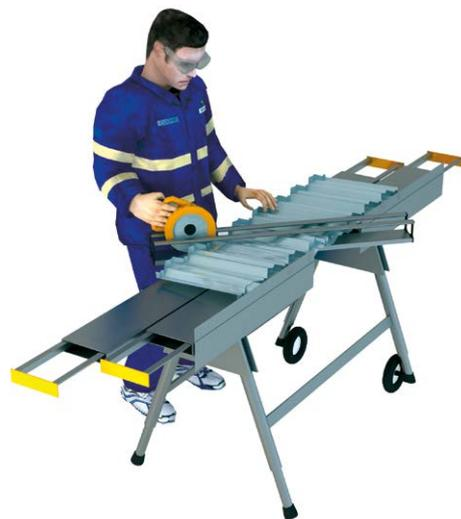
Beim Schneiden der Dachelemente mit einer Säge sollte eine stabile Bank verwendet werden. Verarbeiter sollen immer Sicherheitsausrüstung tragen, die von den Säge- und Klingenerstellern empfohlen wird.
