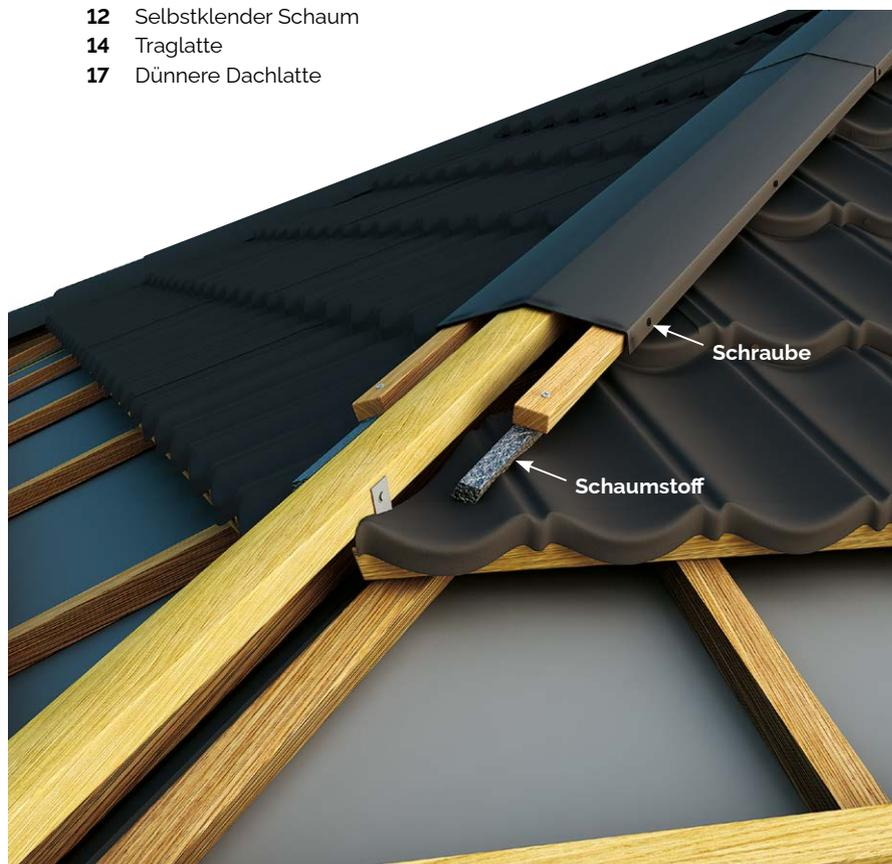
**OPTION 2: Grateindeckung mit Selbstklebeschäum und V-Firstkappe 130 bzw. 180**
